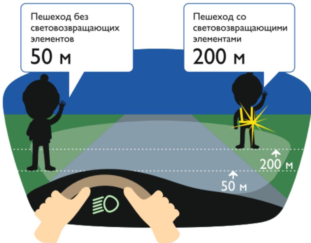
При движении с ближним светом фар водитель автомобиля способен увидеть пешехода на дороге на расстоянии 25-50 метров. Если пешеход применяет световозвращатель, то это
